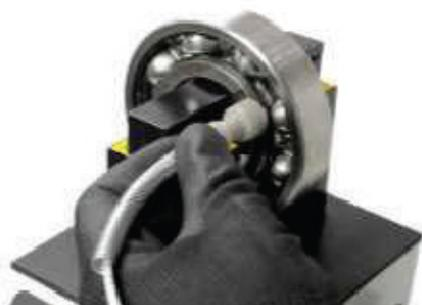
Posicionar o sensor de temperatura magnético no anel interno da peça a ser aquecida. Passar pasta térmica no sensor para melhor leitura da temperatura;
